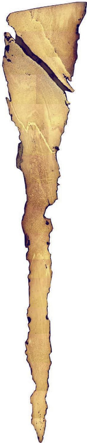
Abb. 28. Überackern-Langsax A-1784, Übersicht des Schneidmaterials, Ätzung mit Nital.
