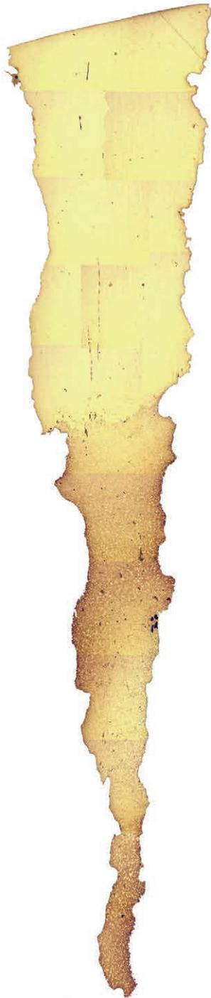
Abb. 21. Überackern-leichter Breitsax A-1783, Übersicht des Schneidmaterials, Ätzung mit Nital.
