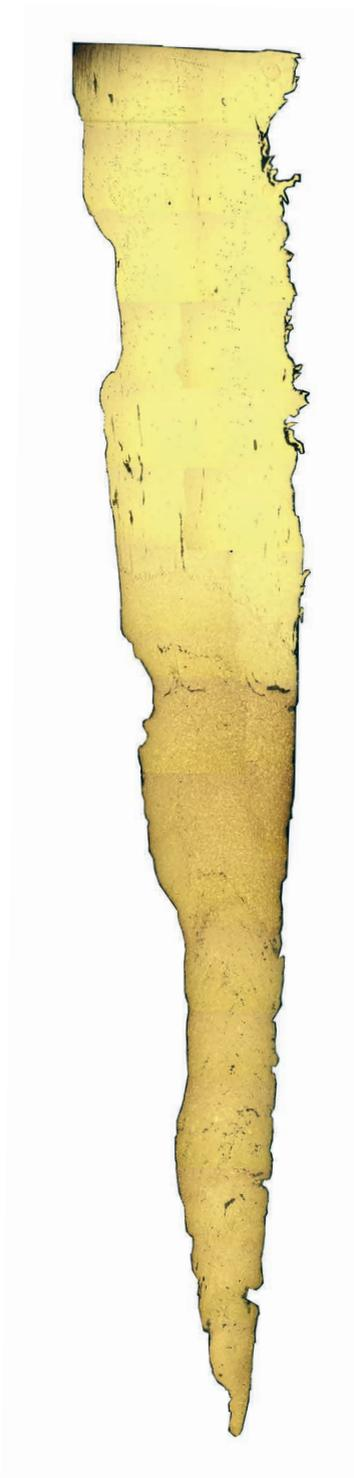
Abb. 7. Überackern-Langsax A-1775, Übersicht des Schneidmaterials, Ätzung mit Nital.
